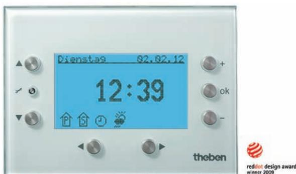
Zentralsteuerung und Überwachung der Gebäudefunktionen werden mit dem Multifunktionsdisplay LUXOR 426 ganz einfach. Es besitzt die Funktionalität einer astronomischen Zeitschaltuhr, dient zum Auslösen der Zentralfunktionen und bietet eine Umschaltung zwischen Hand- und Automatikbetrieb. Das Gerät besitzt eine Sommer-/Winterzeitautomatik, 8 Kanäle mit freier Zuordnung und die Möglichkeit, Kanäle und Gruppen frei zu benennen.
