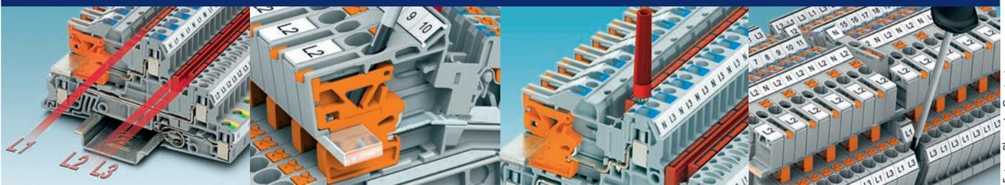
**Bei der Funktionalität** weisen die PTI- und UTI-Installationsklemmen viele Gemeinsamkeiten auf. Für die schnelle und individuelle Potenzialverteilung sind die Dreistockklemmen pro Etage mit doppelten Brückenschichten ausgestattet. Mit einfachen, selbst konfektionierbaren Steckbrücken werden Querverbindungen beliebig vervielfacht. Auch Dreiphasensysteme mit L1/L2/L3-Potenzialen lassen sich überspringend innerhalb einer Klemmengruppierung realisieren.
