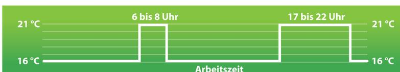
Diese als Beispiel gezeigte Temperaturkurve für eine Einzelraum-Temperatursteuerung macht das Einsparpotenzial im Bereich des Heizens deutlich. Das Senken der Raumtemperatur um nur ein Grad senkt den Energieverbrauch um sechs Prozent. Rechts die formschöne »Energiesparhilfe« von Berker – der TS Sensor mit Raumtemperatursteuerung.
