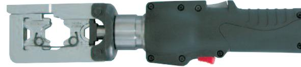
Smart-Line SH-6: Presskraft 60 kN; aufklappbar, mit Schnellöffnung
