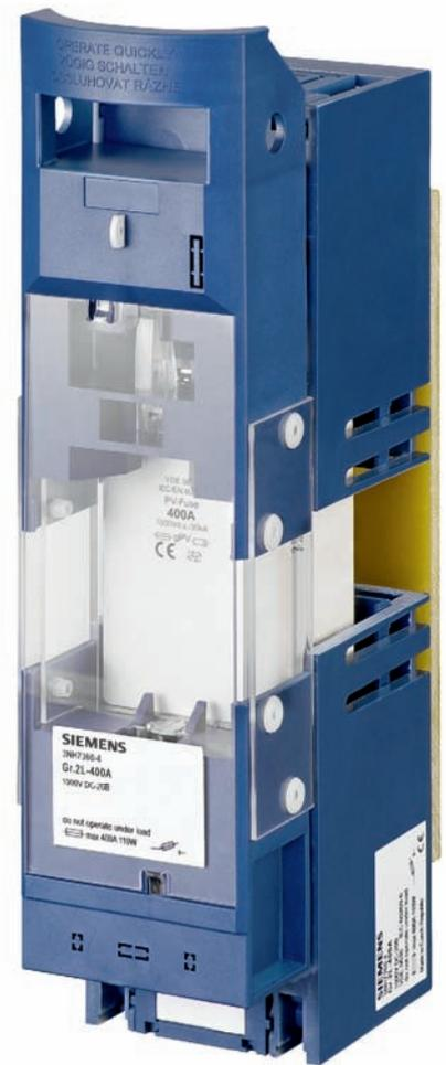
Die NH-Sicherungen der Baugrößen 1 bis 2L können zur Absicherung von Gruppen oder als Summsicherung vor dem Wechselrichter eingesetzt werden. Sie entsprechen den Sicherheitsanforderungen für Photovoltaik-Anlagen nach IEC 60269-6 und gewährleisten dank eines umfassenden Berührungsschutzes eine besonders hohe Betriebs- und Bediensicherheit.
