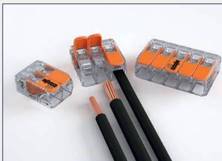
Die Serie 221 ist verfügbar als 2-, 3- und 5-Leiter-Klemmen: Die Serie 221 kontaktiert Leiter mit Querschnitten von 0,14 bis 4 mm 2 feindrähtig und 0,2 bis 4 mm 2 ein- und mehrdrähtig sicher und zuverlässig.
