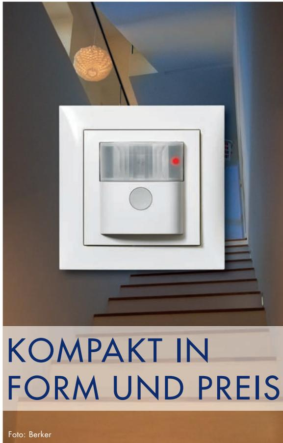
Die Ansprechhelligkeit und Auslöseempfindlichkeit lassen sich über zwei Potenziometer am Gerät manuell einstellen. Die fest eingestellte Nachlaufzeit beträgt drei Minuten. Die voreingestellte Ausschaltvorwarnung blinkt einmal kurz jeweils 30 Sekunden und 15 Sekunden vor Ende der Nachlaufzeit. Über die mittlere Bedientaste kann die Ausschaltvorwarnung bei Bedarf deaktiviert werden.
