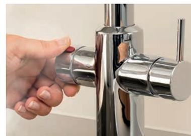
Die Heißwasserarmatur liefert sofort heißes Wasser für Tee oder zum Blanchieren. Der Druck-Dreh-Mechanismus schützt vor Verbrühung: Erst wenn die rote Tastensperre mit dem Daumen während des Drehvorgangs gedrückt und die Sicherheitsperre somit überbrückt wird, kann heißes Wasser fließen.
