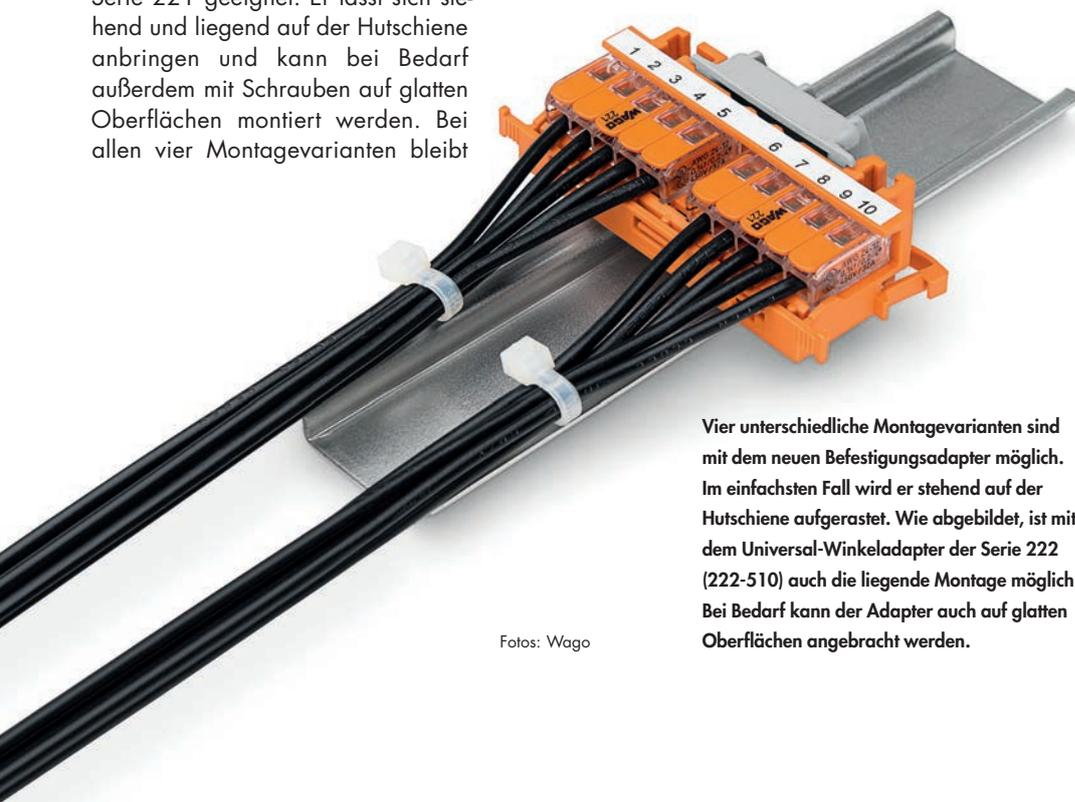
Vier unterschiedliche Montagevarianten sind mit dem neuen Befestigungsadapter möglich. Im einfachsten Fall wird er stehend auf der Hutschiene aufgerastet. Wie abgebildet, ist mit dem Universal-Winkeladapter der Serie 222 (222-510) auch die liegende Montage möglich. Bei Bedarf kann der Adapter auch auf glatten Oberflächen angebracht werden.
