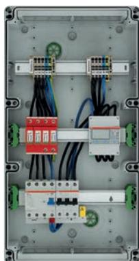
Die Comfort Varianten enthalten zusätzlich einen Überspannungsschutz Typ 2 zum Schutz der Ladeelektronik und einen Zwischenzähler zur Information über den Stromverbrauch des Fahrzeugs.
