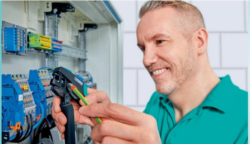
Die Aderendhülse bleibt das wohl am häufigsten verarbeitete Medium bei der Verdrahtung von Komponenten in Schaltanlagen und Schaltschränken. Wer damit verdrahtet, benötigt prozesssichere, komfortable und ermüdungsarme Werkzeuge. Mit der neuen Crimpfox Duo 10 bietet Phoenix Contact jetzt eine Crimp-Zange, die neben der seitlichen und frontalen Verdrahtung weitere Vorteile aufweist und ein ermüdungsfreies Arbeiten ermöglicht.
