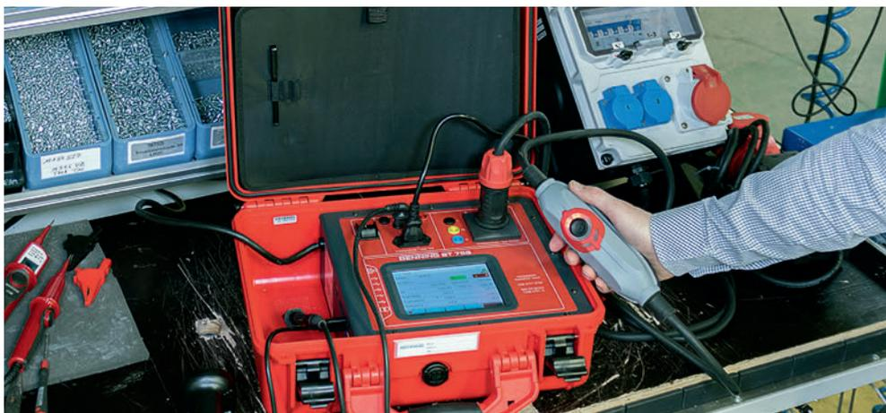
**Die korrekte Prüfung** mobiler Personenschutzschalter stellt die Prüfer in der Regel vor eine schwierige Aufgabe – die neuen **Gerätetester** BENNING ST 755 bzw. ST 760 erleichtern diese Aufgabe
