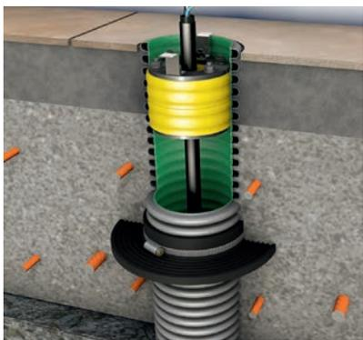
Das extrem weiche Außenmaterial der Innendichtung Kabu-IN DD schmiegt sich optimal an das Rohr an und dichtet es so sicher ab.
