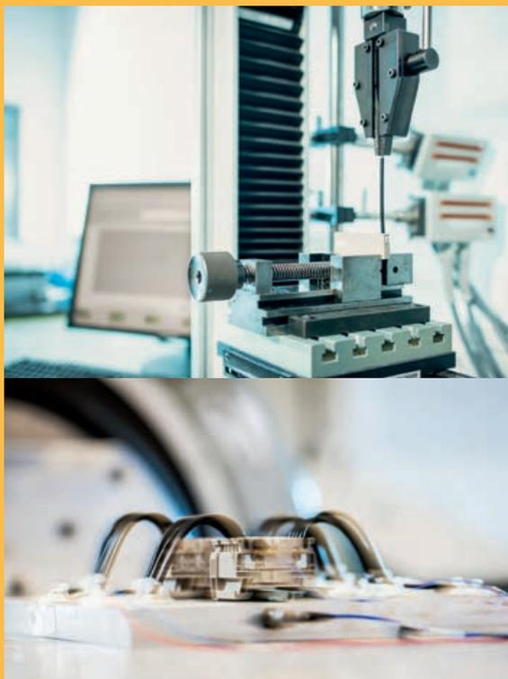
Das Foto links oben zeigt die Zugprüfung. Die PUSH IN-Anschluss-technik ist nach dem Druckfeder-Prinzip konzipiert. Der Vorteil sind hohe Leiterausziehkräfte. Darunter ein Foto vom Vibrationstest. Um die zuverlässige, rüttelsichere und gasdichte Verbindung zu sichern, durchlaufen die Produkte vielfältige Prüfungen im Labor.
